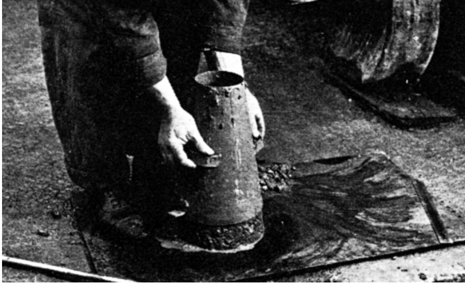
شكل (١٠-٣) رفع القالب بعد ملئه في إتجاه رأسى.
