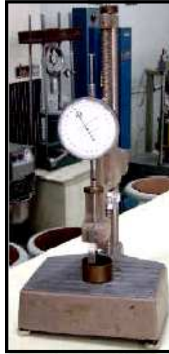
جهاز الغرز وبه الإبرة طول ٥٠ مم وقطر ١ مم
