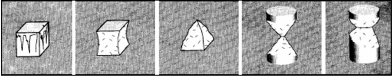
شكل انهيار صحيح لعينات إختبار في الضغط
