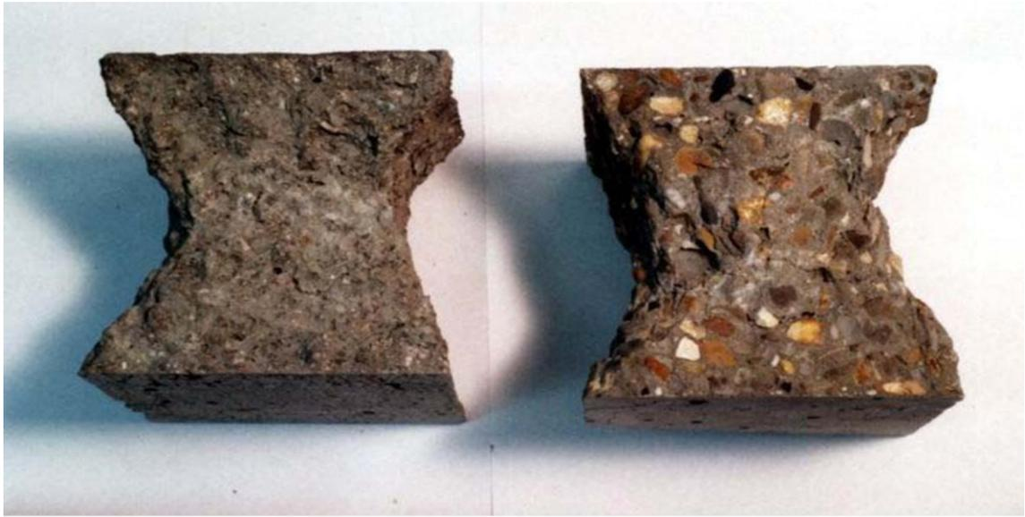
شكل الكسر في عينات خرسانيه مكعبه بعد إجراء إختبار الضغط عليها
