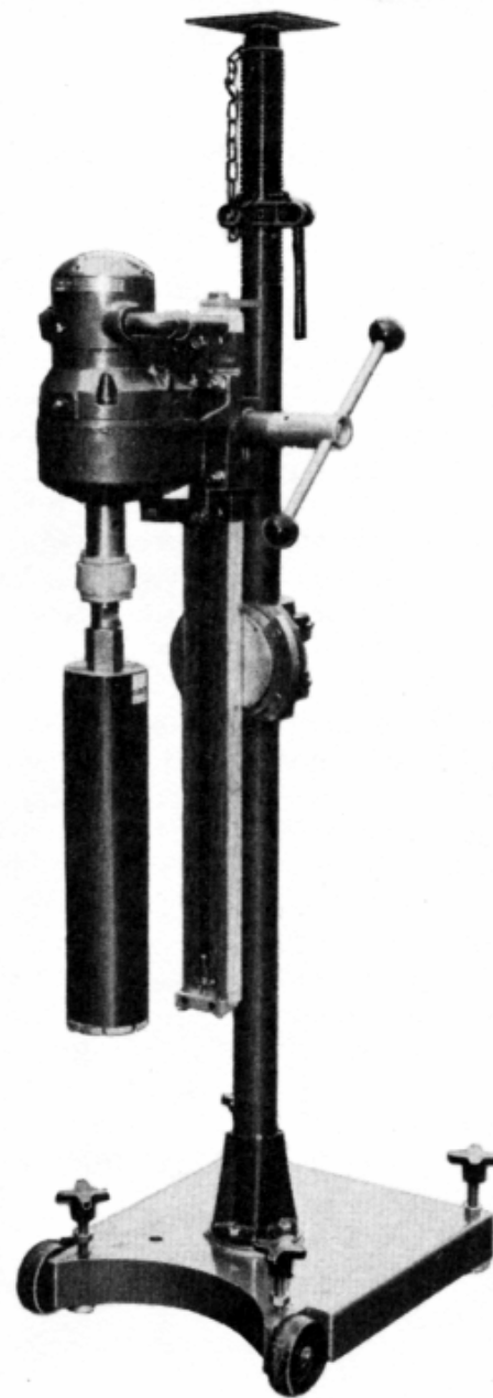
جهاز القلب الخرساني وأخذ عينه أفقيه من الحائط
