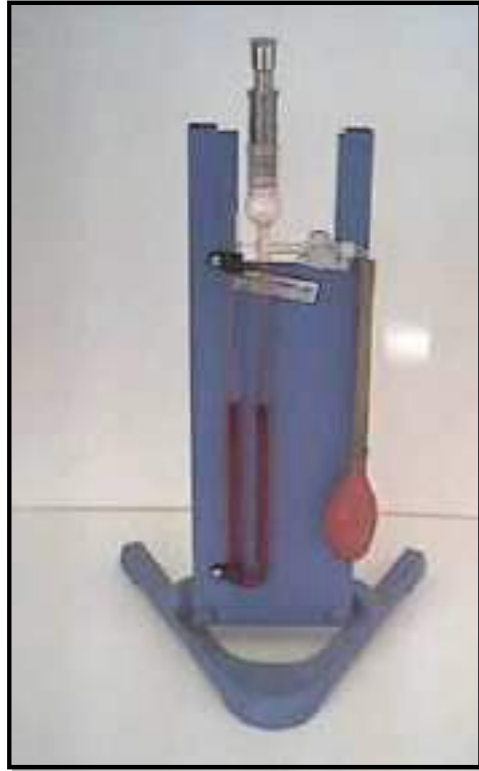
شكل (٢-١٥) صورة لجهاز بلين لتعين نعومة الأسمنت
